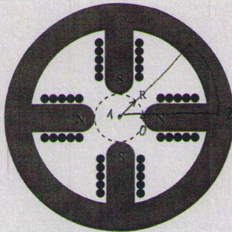
a) Finden Sie einen geeigneten Integrationsweg für  $\oint \mathbf{H} ds$  zwischen den Polschuhen des Quadrupolmagneten und geben Sie so einen Ausdruck für die Größe Amperewindungszahl  $NI$  an. Es soll davon ausgegangen werden, dass das Magnetfeld im Zentrum des Quadrupols ( $r < R$ ) einen konstanten Feldgradienten  $B' = B_0/R$  besitzt, wobei  $B_0$  der maximale Feldbetrag an der Polspitze  $r = R$  auftritt.
